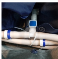
Válvula unidireccional en el circuito de mangueras
