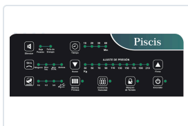
Panel de la unidad de control
